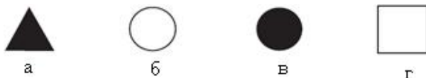
Рис. 6. Знаки обозначения для модулей: а – модуля контроллера; б – периферийный модуль PXI; в – периферийный модуль PXIe; г – тактовый модуль
