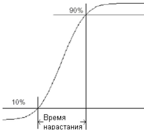
Рис. 4. Определение времени нарастания сигнала
